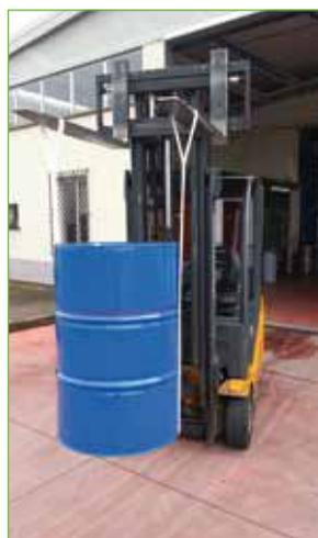
Imbragatura "usa e getta" per sollevamento fusti ammalorati in polipropilene, nastro di sollevamento da far passare sotto al fusto da sollevare nastro circolare da legare intorno alla circonferenza del fusto (adattabile a qualsiasi diametro) per dare stabilità durante il sollevamento 2 asole di presa ricavate nel nastro di sollevamento mediante cucitura.
