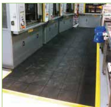
Tappeti modulari interbloccanti che permettono la personalizzazione in loco. Sono divisi in unità di varie dimensioni, possono essere assemblate senza fatica e distese da parete a parete o come isole centrali in qualunque direzione e forma.
